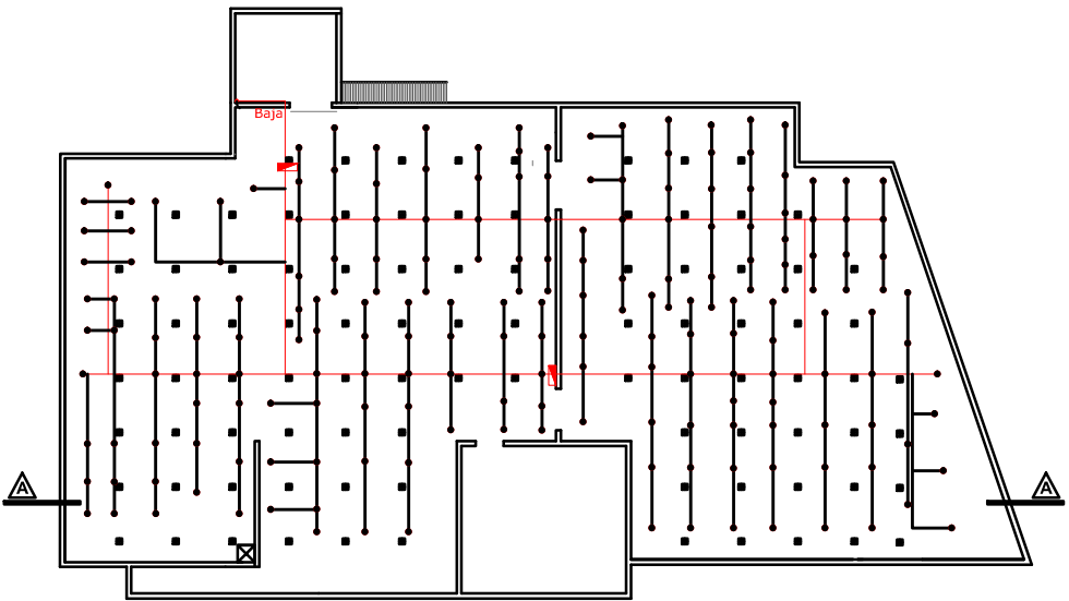
DETALLE DE UBICACION DE ROCIADORES AUTOMÁTICOS Y BIES BODEGA DE MATERIA PRIMA
